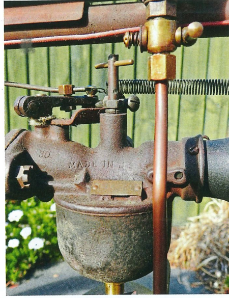
Den altherwürdigen Vergaser hat der Neuseeländer einem Automobil entliehen – einem Ford Model T
