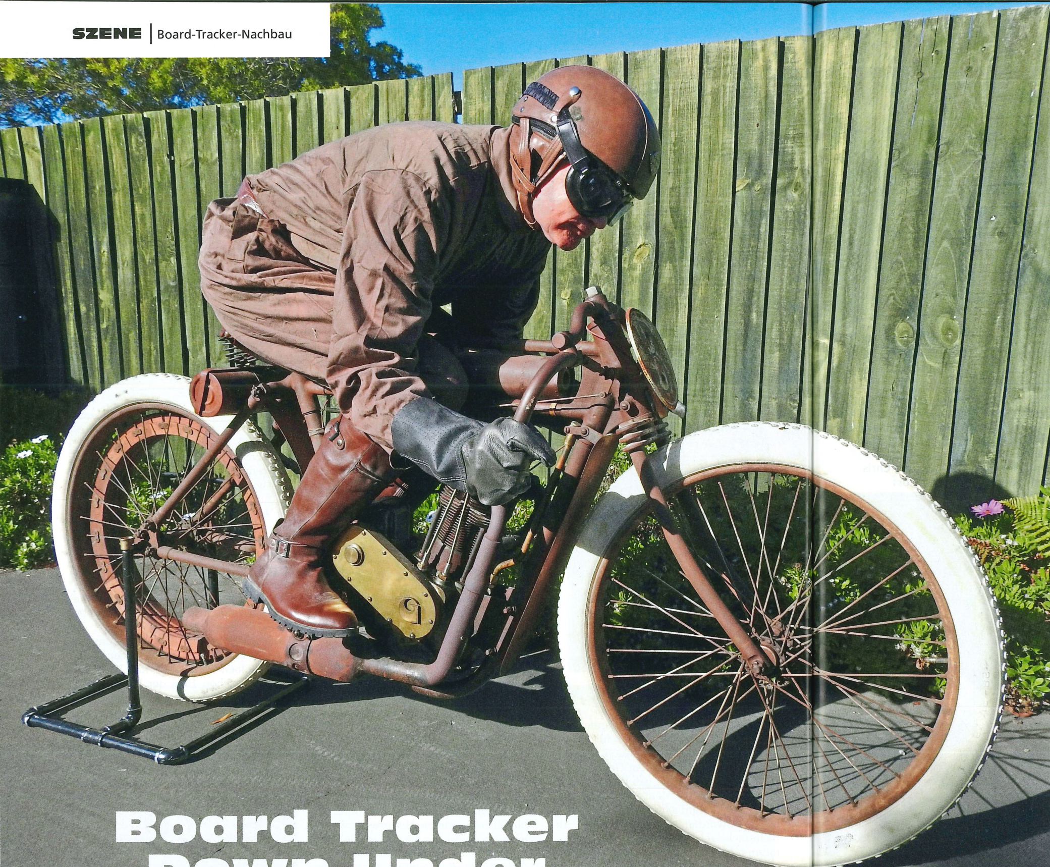
Als Basis seines Eigenbaumotors diente Chris Gordon das Kurbelgehäuse eines JAP-Motors inklusive Kurbelwelle
