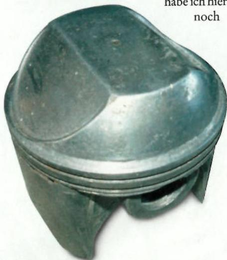
**Selbst gegossener und fertig bearbeiteter Kolben, ursprünglich für eine 500er-Velocette**
