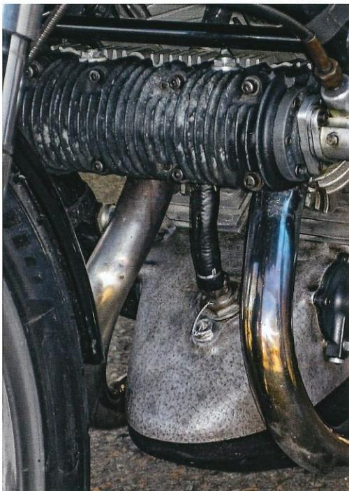
Die 1947 präsentierte AJS E 90 mit ihren fast liegenden Zylindern basierte auf einer Kompressor-Vorkriegskonstruktion. Erst die ab 1952 eingesetzte E 95-Version mit kompaktem 45 Grad Zylinderwinkel und extrem tief reichenden Tankflanken brachten das Fahrverhalten ein gutes Stück voran. An Leistung mangelte es dem Twin dennoch
